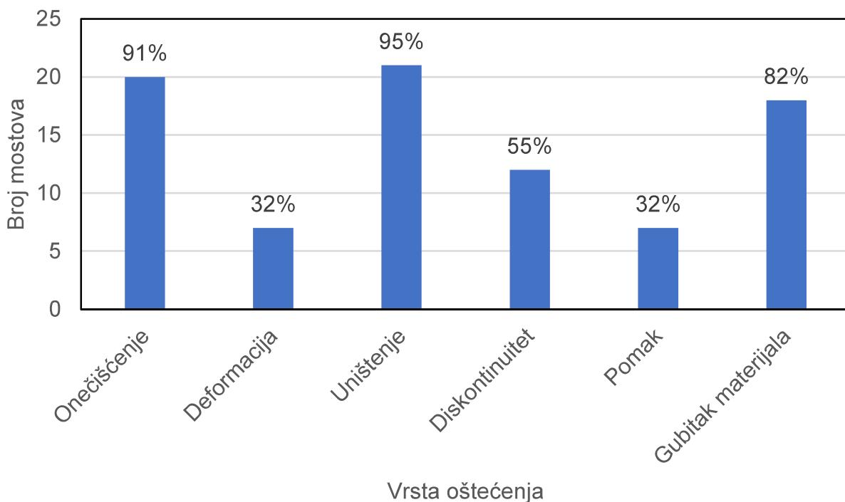
**Slika 3.** Učestalost vrsta oštećenja na zidanim svođenim cestovnim mostovima na temelju *in-situ* vizualnog pregleda
