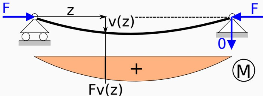
Момент внутри балки определяется уравнением упругой кривой:
