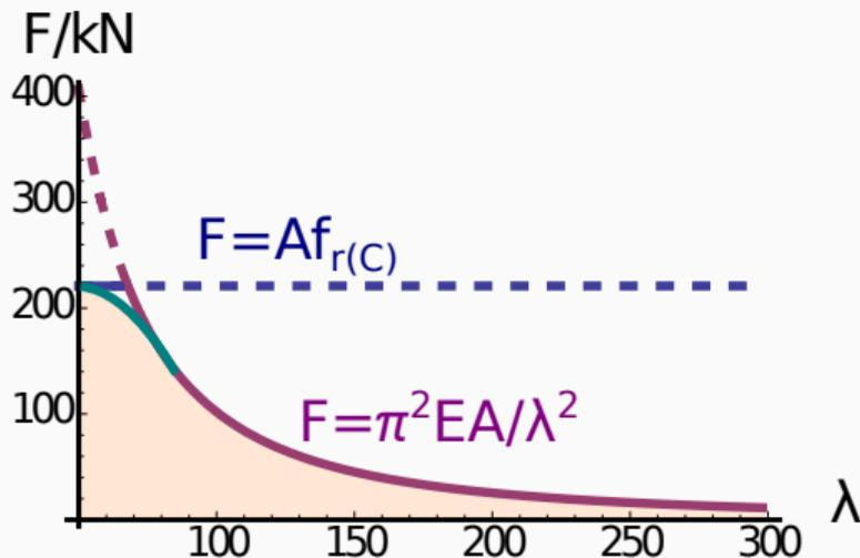
Стальной стержень (круглое сечение, диаметр 25 мм),  $E = 210$  GPa,  $f_{r(C)} = 450$  MPa
