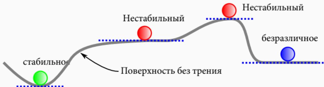
*Твердое тело (шар) на поверхности без трения, гравитационное поле. Равновесие обеспечивается там, где касательная к поверхности горизонтальна, но только зеленый шар находится в состоянии устойчивого равновесия*
