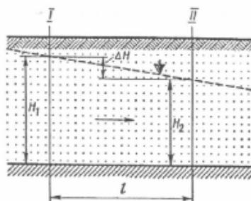
Рисунок 5- Схема движения (фильтрации) грунтовой воды [10]
