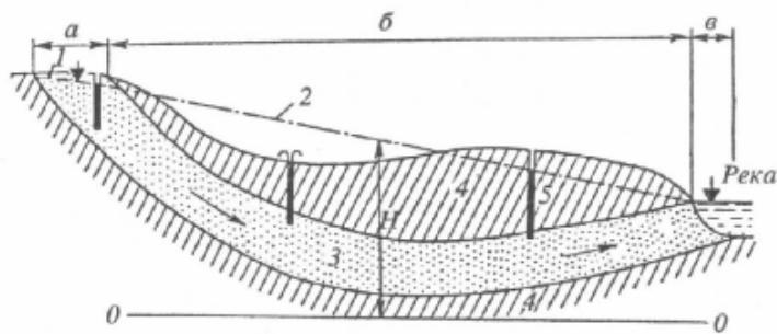
Рисунок 2 – Артезианский бассейн (в условиях синклинального залегания слоев пород). Области: а – питание напорных вод; б – напор; в – разгрузки; 1 – уровень грунтовых вод; 2 – пьезометрический уровень напорных вод; 3 – водоносный напорный пласт; 4 - водоупоры; 5 – скважины; Н – величина пьезометрического напора [1]
