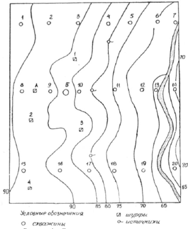
Рисунок 4 – Схема гидроизогипс и пьезоизогипс
