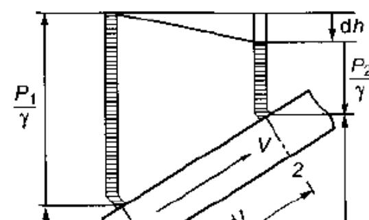
силы тяжести и (или) градиента давления. Для анализа сил, определяющих фильтрацию, рассмотрим уравнение Бернулли для потока идеальной жидкости, проходящего через трубку, изображенную на рис. 5.1:
