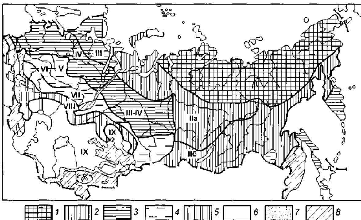
Рис. 7.9. Схема зональности грунтовых вод территории бывшего СССР (по О.К. Ланге); зоны распространения: 1 — сплошной вечной мерзлоты; 2 — таинковой (IIa) и островной (IIб) мерзлоты; 3 — тундровых вод (III), высоких вод севера (IV); 4 — неглубоких оврагов (V), глубоких оврагов (VI) и овражно-балочная (VII); 5 — неглубоких балок Прикаспия (VIII); 6 — равновесия подземного стока и испарения (IX); 7 — подося (зона) подгорных шлейфов и предгорных равнин (X); 8 — области азональных грунтовых вод
