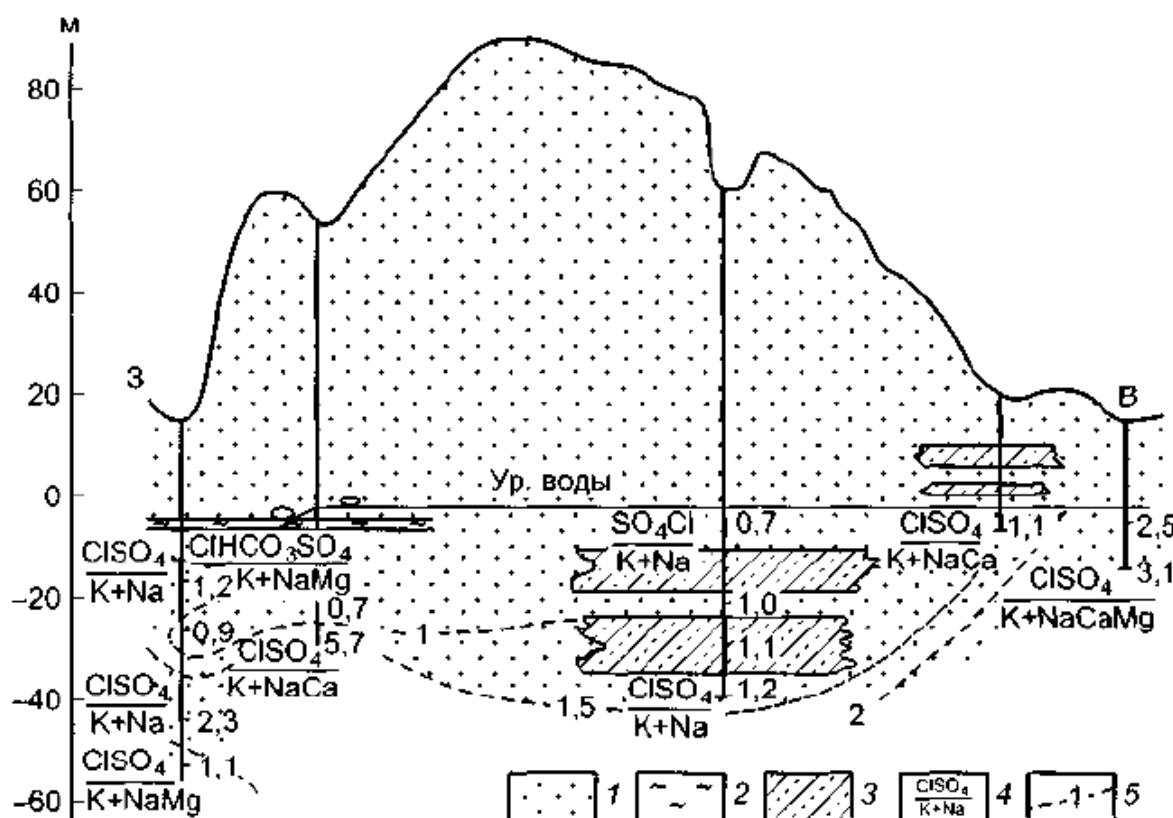
Рис. 13.8. Разрез через линзу пресных вод песков Черкезли, Туркмения (по Н.Г. Шевченко, 1963): 1 — пески; 2 — глины; 3 — прослон глин, суглинков и супесей; 4 — химический состав подземных вод; 5 — изолинии минерализации, цифры — минерализация подземных вод, г/л
