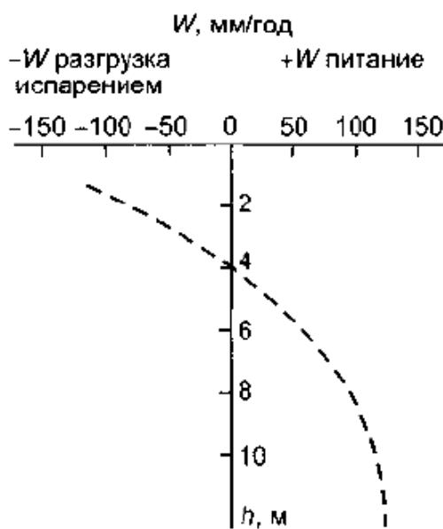
Рис. 7.6. Характер изменения величины инфильтрационного питания и разгрузки грунтовых вод испарением в зависимости от глубины их залегания (по И.С. Пашковскому)
