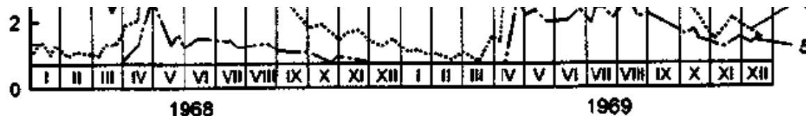
Рис. 9.9. Характер изменения дебитов родников (1—5) из палеозойских карбонатных отложений бассейна среднего течения р. Чусовой (Ср. Урал). В числителе — дебит (л/с) источника 667 (1) в периоды максимальных значений, в знаменателе — дата наблюдения
