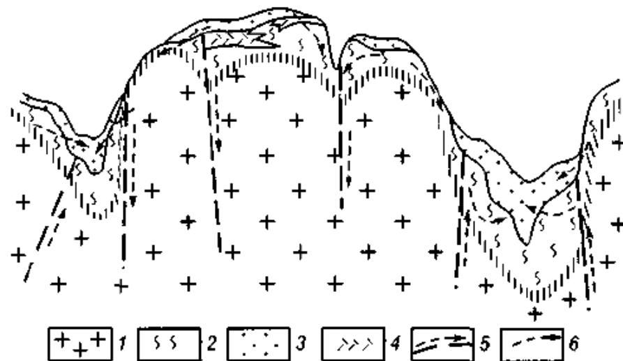
*Рис. 11.1. Схема строения гидрогеологического массива: 1 — древние кристаллические породы; 2 — зона экзогенной трещиноватости; 3 — рыхлые или слабосцементированные осадочные отложения; 4 — образования коры выветривания; 5 — возможные направления потоков трещинно-жильных вод; 6 — направления движения трещинно-грунтовых вод зоны экзогенной трещиноватости*
