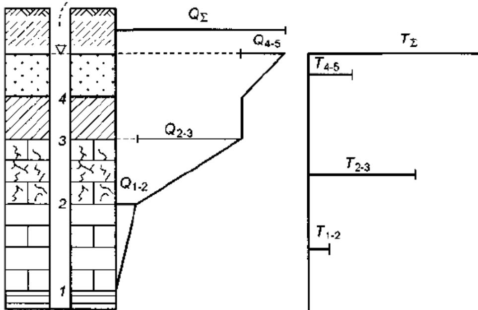
*Рис. 18.5. Графики результатов расходометрических исследований скважины: 1–4 — границы слоев, выделенных в разрезе скважины. Остальные обозначения даны в тексте*
