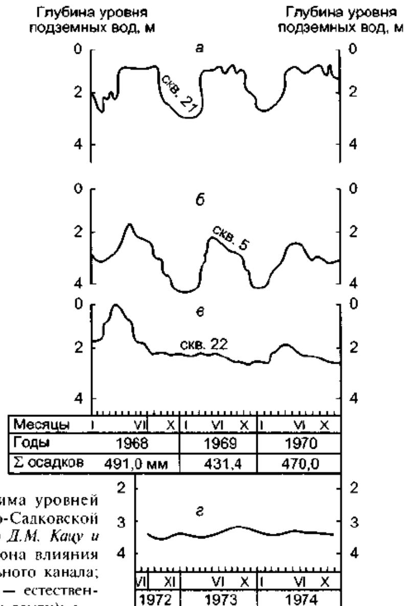
*Рис. 13.7. Графики режима уровней подземных вод Богасевско-Садковской оросительной системы (по Д.М. Кацу и В.М. Шестакову): а — зона влияния магистрального оросительного канала; б — орошаемые земли; в — естественные условия (неорошаемые земли); г — орошаемые земли в зоне влияния коллекторно-дренажной сети*
