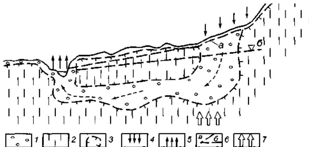
*Рис. 12.4. Схема возможного формирования потока межмерзлотных подземных вод: 1 – относительно высокопроницаемые талые породы; 2 – ММП; 3 – границы ММП; 4 – участок (область) сосредоточенного питания межмерзлотных вод; 5 – участок разгрузки; 6 – положение уровня подземных вод в период формирования их питания (а) и в период отсутствия питания (б); 7 – возможный приток более глубоких (межмерзлотных, подмерзлотных) подземных вод*
