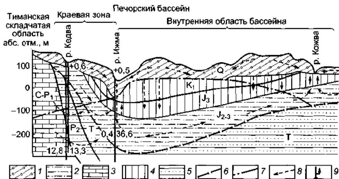
*Рис. 10.8. Схема гидродинамической зональности юго-западного борта Печорского артезианского бассейна: 1 — водоносный комплекс четвертичных отложений; 2 — верхне-среднисюрских; 3 — каменноугольных и пермских отложений; слабопроницаемые породы: 4 — нижнемелового—среднисюрского возраста; 5 —*
