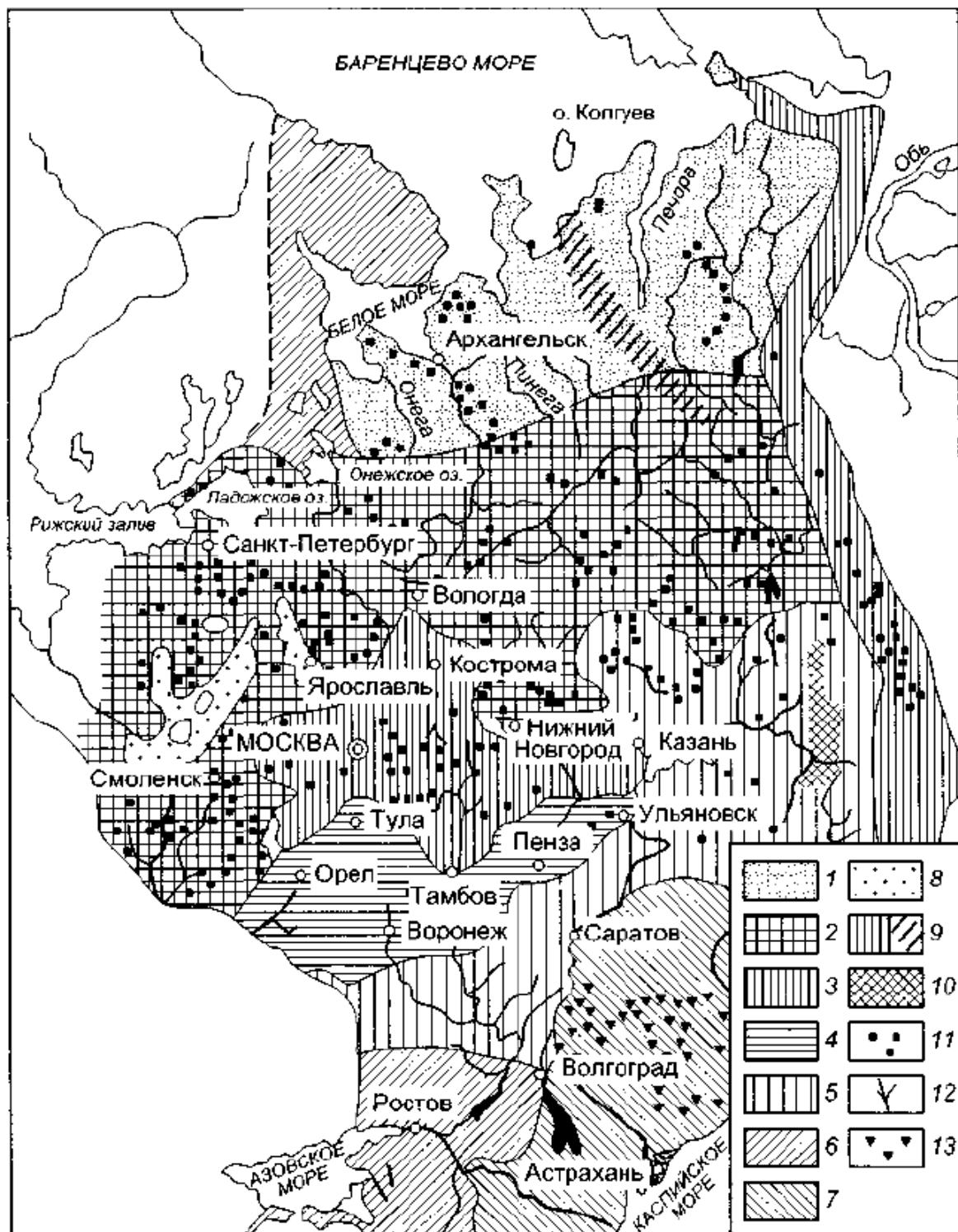
*Рис. 7.8. Схема зональности грунтовых вод территории европейской части России (по В.С. Ильину). Зоны: 1 — тундровых вод, 2 — высоких вод Севера, 3 — неглубоких оврагов, 4 — глубоких оврагов, 5 — овражно-балочная, 6 — прichernноморских баток, 7 — прикаспийских баток; области распространения азотильных вод: 8 — конечных морен, 9 — массивных пород, 10 — карста, 11 — болот, 12 — аллювиальных вод, 13 — солончаков*
