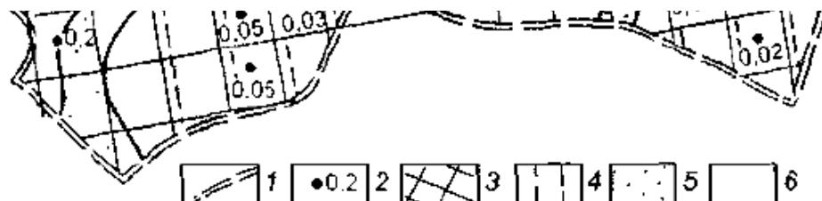
*Рис. 13.1. Распределение величин инфильтрационного питания на территории Пришильской равнины (южная часть Западно-Сибирской низменности): 1 — границы расчетного участка; 2 — расчетный блок, цифра — величина инфильтрационного питания, л/с · км<sup>2</sup>; 3—6 — величины инфильтрационного питания, л/с · км<sup>2</sup>; 3 — менее 0,01; 4 — 0,01—0,1; 5 — 0,1—0,2; 6 — 0,2—0,5*
