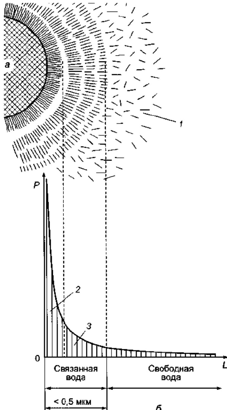
Рис. 2.2. Схема взаимодействия сил в системе твердая частица—вода (Крайнов и др., 2004, по Н.А. Цитовичу): а — схема расположения молекул воды в пределах диффузионного слоя твердой частицы, б — эпюра изменения поверхностных сил ( $P$ ) в зависимости от расстояния до минеральной частицы ( $L$ ); 1—3 — вода: 1 — свободная, 2 — адсорбированная “прочносвязанная”, 3 — поверхностных слоев “рыхлосвязанная”
