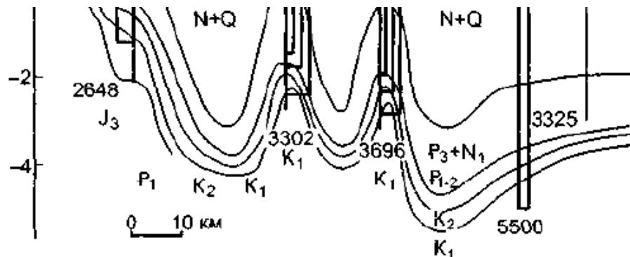
*Рис. 10.6. Проявления аномально высоких пластовых давлений (АВПД) в песчано-глинистых отложениях мел-палеогена Восточно-Предкавказского артезианского бассейна (по И.Г. Киссину, 1967). Стрелками показана величина напора межпластовых вод, вскрытых буровыми скважинами. Цифры – абсолютные отметки установившегося (расчетного) уровня межпластовых вод, м*
