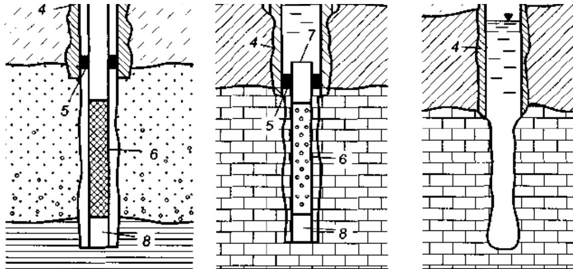
*Рис. 18.1. Принципиальная конструкция гидрогеологических скважин (Полевые методы..., 2000): а — с фильтровой колонной, выведенной на устье; б — с фильтром "впотай"; в — без фильтра. 1 — кондуктор; 2 — затрубная цементация; 3 — эксплуатационная колонна; 4 — затрубно-межтрубная цементация; 5 — сальник (тампон); 6 — фильтр; 7 — глухие надфильтровые трубы; 8 — отстойник*
