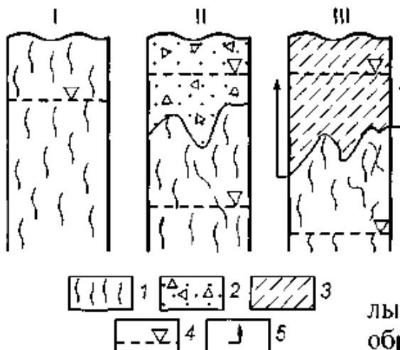
Рис. 9.2. Различные схемы строения зоны аэрации массивов трещиноватых пород: 1 — трещиноватые скальные породы, 2 — рыхлые хорошо проницаемые отложения, 3 — рыхлые — слабопроницаемые, 4 — уровень грунтовых вод; 5 — местный напор грунтовых вод
