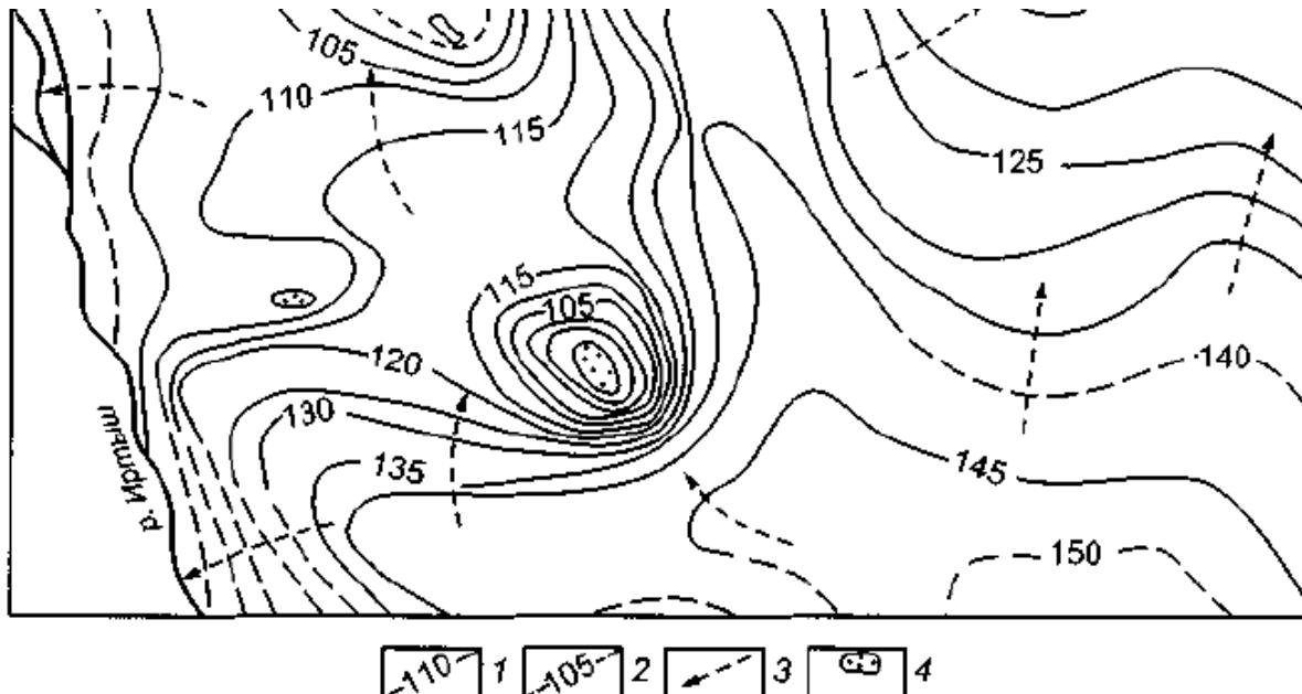
*Рис. 13.4. Схема грунтового потока Прииртышской равнины (южная часть Западно-Сибирской низменности): 1 — гидроизогипсы, цифры — абр. отм., м; 2 — то же, по ограниченным данным; 3 — направления движения грунтовых вод; 4 — соленые озера*
