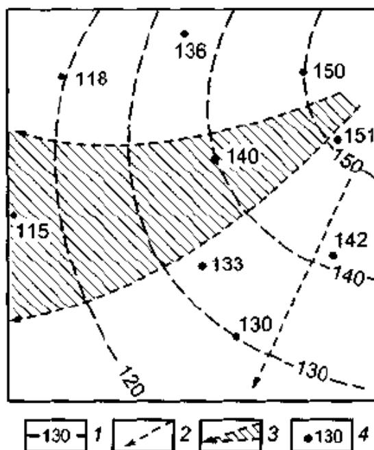
Рис. 5.5. Гидродинамическая сетка потока подземных вод
