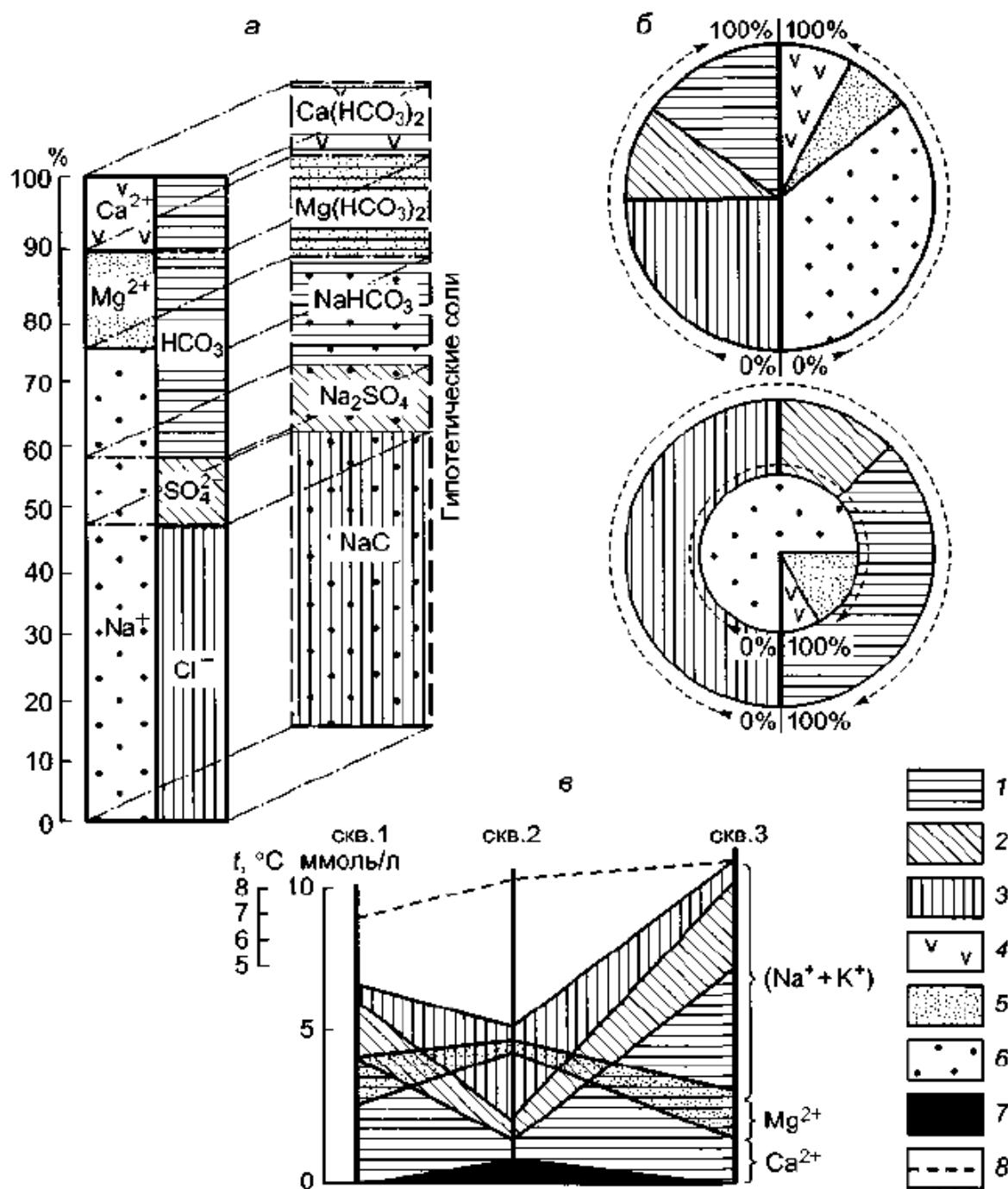
Рис. 4.4. Графические способы выражения химического состава воды: а — график-прямоугольник (пунктир — “гипотетические” соли); б — круги-диаграммы; в — гидрохимический профиль (по А.А. Бродскому):
