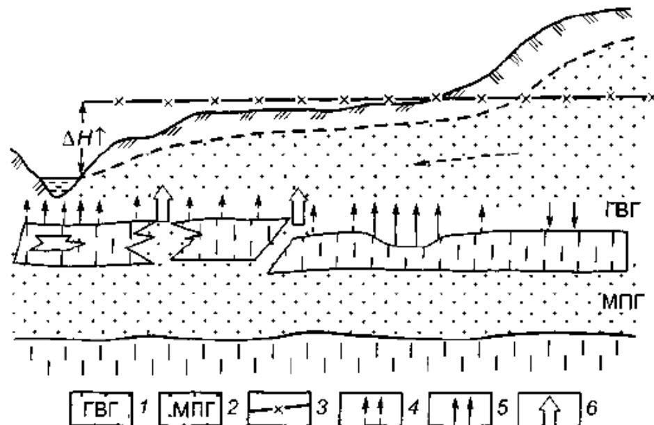
*Рис. 7.3. Схема формирования питания грунтовых вод за счет фильтрации из нижележащего водоносного горизонта: 1 — грунтовые воды; 2 — межпластовый водоносный горизонт; 3 — пьезометрический уровень межпластовых вод; 4 — затрудненная рассредоточенная фильтрация (перетекание); 5 — локальное интенсивное перетекание; 6 — фильтрация по "гидрогеологическим окнам" (остальные обозначения см. рис. 7.2)*
