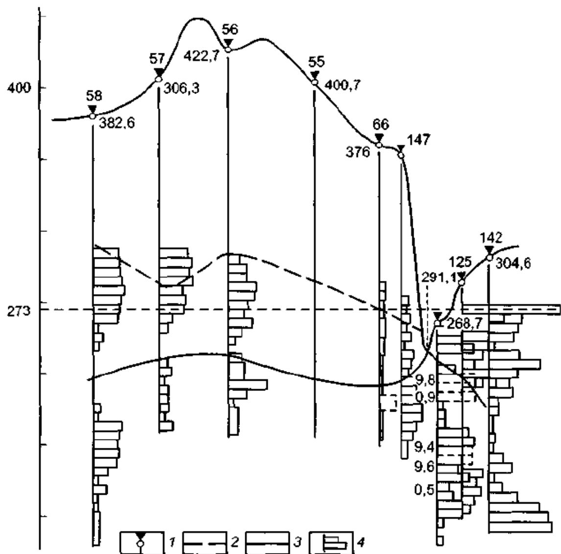
*Рис. 9.8. Характер изменения уровней трещинно-карстовых вод в бассейне р. Цетина (по М. Коматине, 1975): 1 — буровые скважины, цифры — номер скважины и абсолютная отметка устья, м, 2 — положение уровня трещинно-карстовых вод на 15.09.58, 3 — то же на 15.04.58, 4 — величина удельного водопоглощения (1 мм = 1 л/мин · м при избыточном давлении 10 атм ( $10^3$  кПа))*
