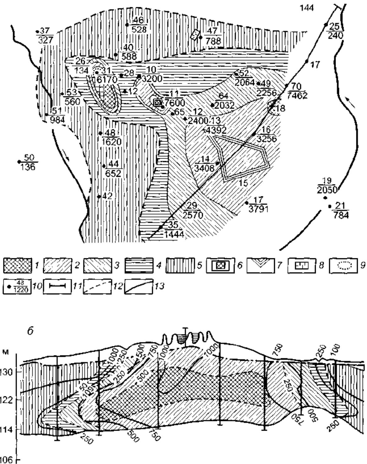
Рис. 16.4. Загрязнение грунтовых вод в районе фармацевтического завода (по Е.Л. Минкину, 1972): а — схематическая карта загрязнения; б — гидрохимический разрез; 1—5 — зоны распространения загрязненных грунтовых вод, различающихся по минерализации, мг/л (1 — выше 10 000; 2 — от 3000 до 10 000; 3 — от 2000 до 3000; 4 — от 1000 до 2000; 5 — от 500 до 1000); 6 — ямы-накопители нейтрализованных кислых вод; 7 — поля фильтрации; 8 — стивные ямы
