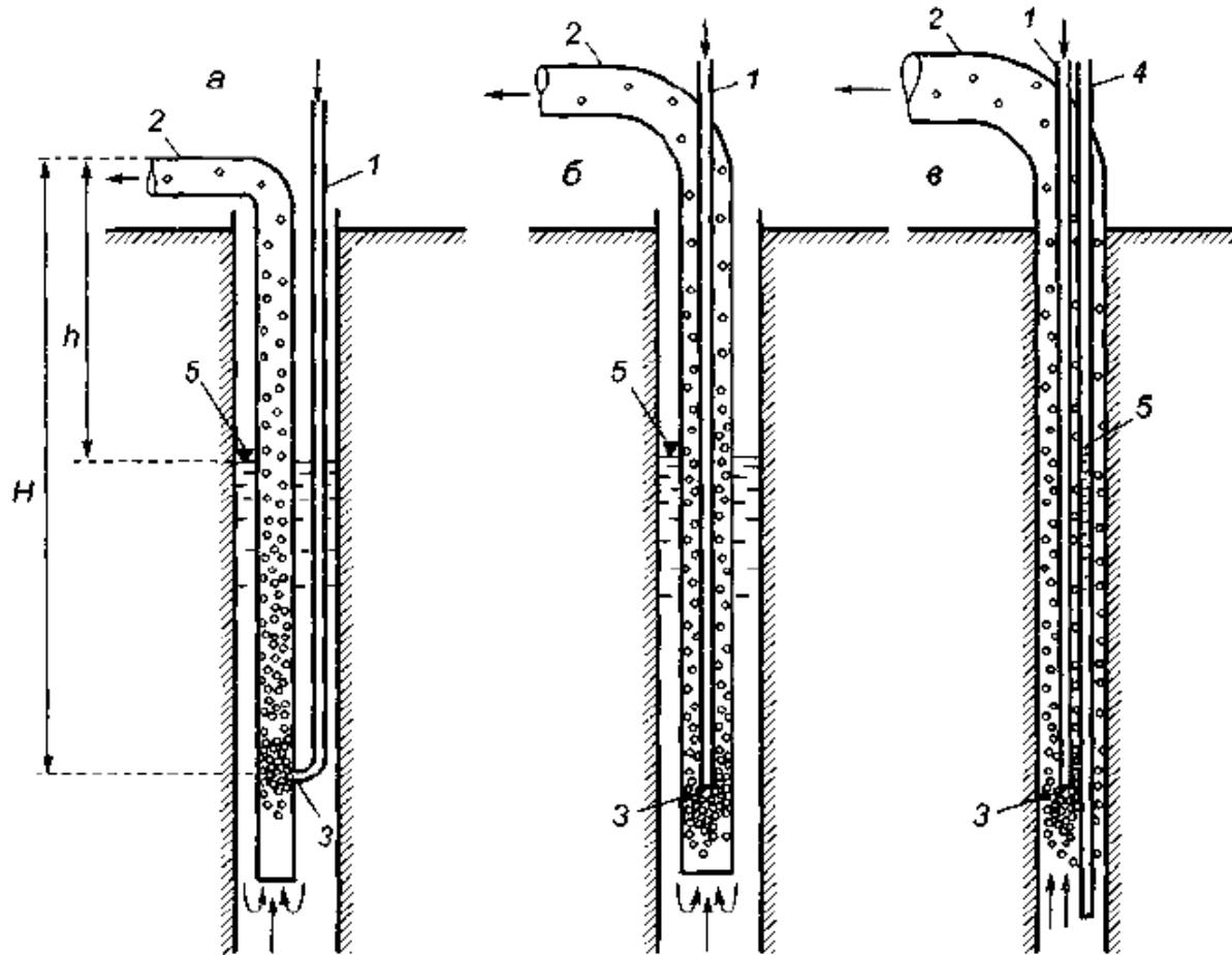
Рис. 18.6. Схемы монтажа эрлифтов (*Полевые методы...*, 2000): а — “рядом”; б, в — “внутри”; 1 — воздухопроводные трубы (от компрессора); 2 — водоподъемные трубы; 3 — форсунка (смеситель); 4 — уровнезамерная трубка; 5 — динамический уровень воды
