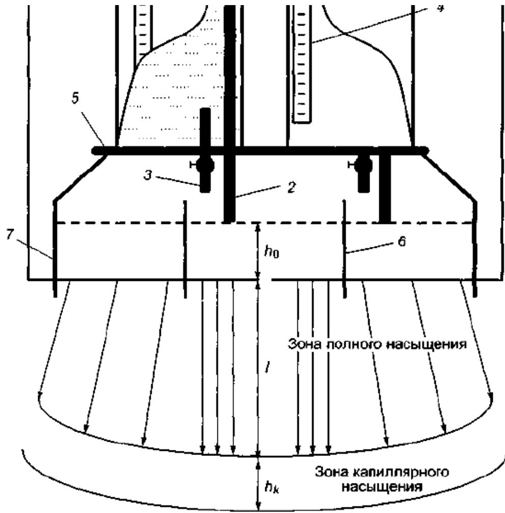
*Рис. 18.2. Схема фильтрации при наливе в кольцевые инфильтрометры (способ Н.С. Нестерова). 1 — мерный бачок (сосуд Мариотта); 2 — “воздушная” трубка; 3 — “водяная” трубка; 4 — водомерная шкала; 5 — штатив; 6 — внутреннее кольцо; 7 — внешнее кольцо (Полевые методы..., 2000)*
