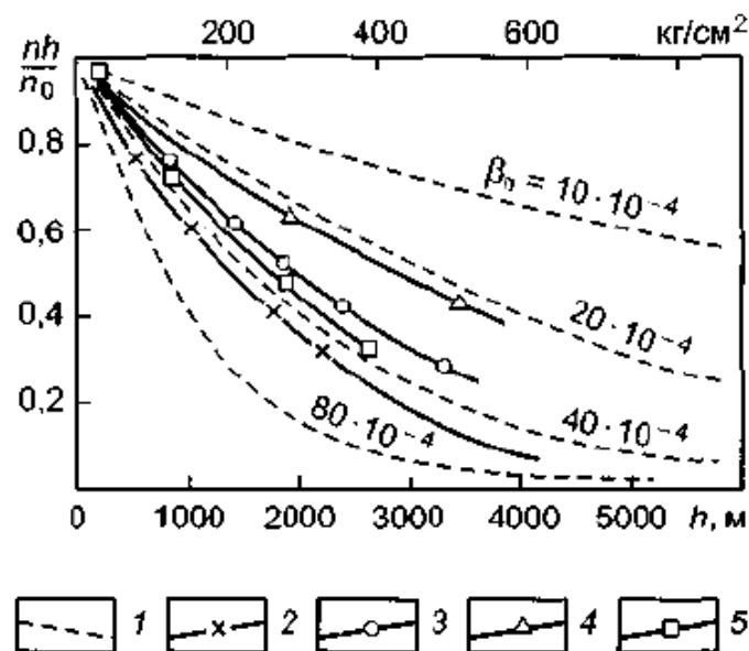
*Рис. 3.3. Необратимое уменьшение коэффициента пористости осадочных пород с глубиной (по В.М. Добрынину, 1970): 1 — теоретические кривые; 2 — третичные глинистые породы Северо-Восточного Предкавказья; 3 — песчаники; 4 — известняки; 5 — мергели;  $\beta_{II}$  — коэффициент необратимого уплотнения*
