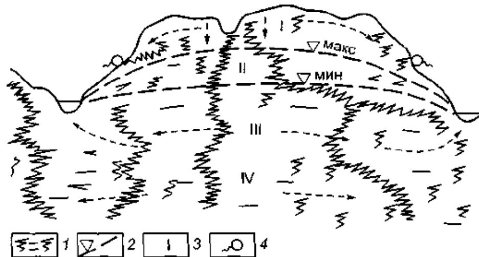
Рис. 9.5. Схема вертикальной зональности карстового массива (по Д.С. Соколову, 1962): 1 — закарствованные горные породы, 2 — уровень грунтовых (трещинно-карстовых) вод, 3 — номера гидродинамических зон, 4 — родники
