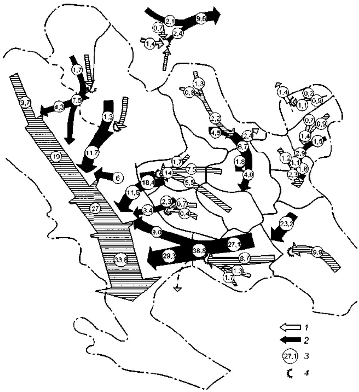
Рис. 9.7. Схема формирования потоков трещинно-карстовых подземных вод, бассейн р. Цетина, Динарийский массив (по М. Коматине, 1975): 1 — потоки поверхностных вод (русловой сток), 2 — потоки трещинно-карстовых вод, 3 — расходы,  $\text{м}^3/\text{s}$ , 4 — участки локального интенсивного поглощения поверхностных вод.
