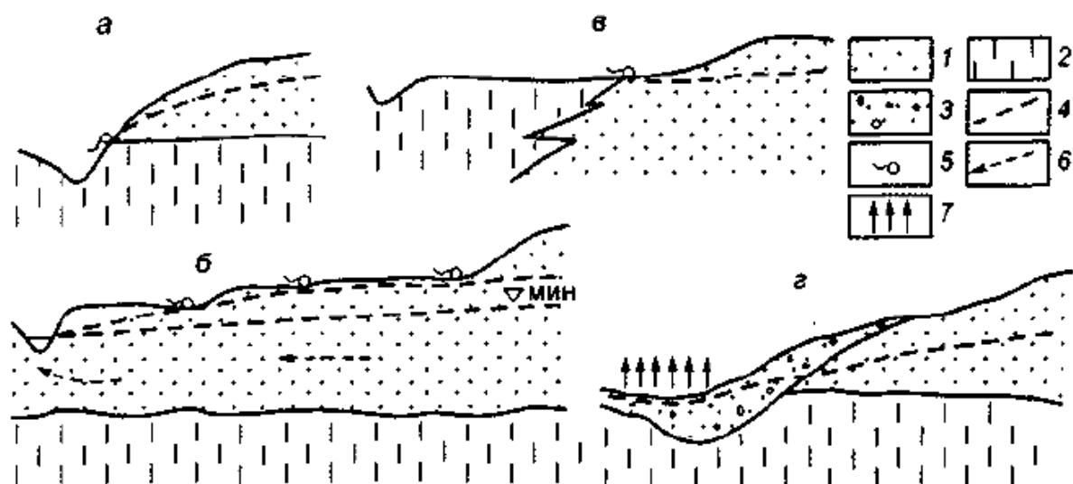
Рис. 7.4. Основные схемы формирования естественных выходов (источников) грунтовых вод: а — контактный; б — депрессионные; в — экранированный; г — субфлювиальный. 1 — проницаемые (водоносные) породы; 2 — слабопроницаемые породы; 3 — рыхлые склоновые образования; 4 — уровень грунтовых вод; 5 — родник; 6 — направление движения грунтовых вод; 7 — разгрузка грунтовых вод испарением
