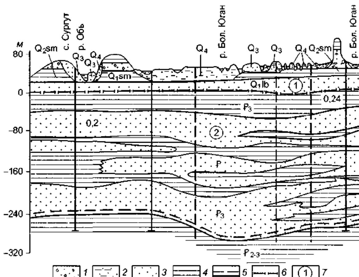
*Рис. 10.7. Схема зональности первого гидрогеологического этажа центральной части Западно-Сибирской артезианской области (гидрагеологический разрез, по Р.П. Глушко, 1963): 1 — песчано-гравийные отложения; 2 — песчано-глинистые; 3 — преимущественно песчаные; 4 — слабопроницаемые глинистые; 5 — нижняя граница первого гидрогеологического этажа; 6 — границы, 7 — номера гидродинамических зон*
