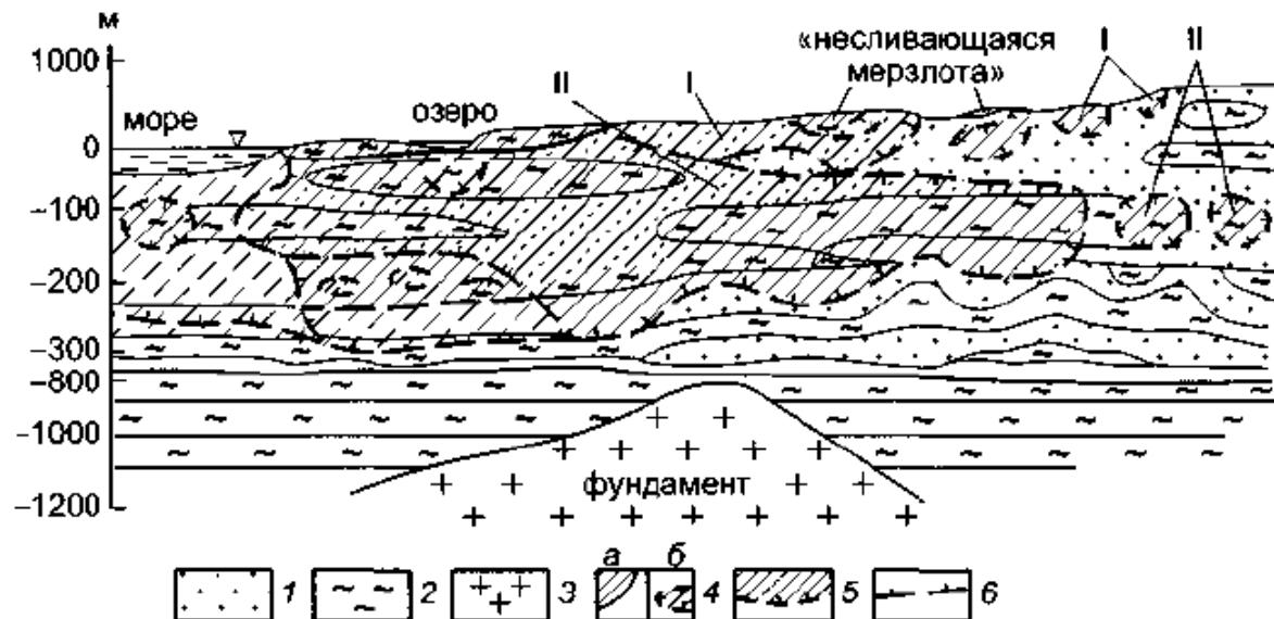
Рис. 12.3. Строение криолитозоны платформенных областей (по Н.Н. Романовскому, 1983): I — плейстоценовые, II — верхнеголоценовые мерзлые толщи; 1 — преимущественно песчаные водоносные породы; 2 — глинистые слабопроницаемые; 3 — породы фундамента; 4 — слой сезонного промерзания (а), многогоднемерзлые породы (ММП) и граница их распространения (б); 5 — охлажденные породы с криогалинными водами и граница их распространения; 6 — граница между плейстоценовыми и верхнеголоценовыми ММП
