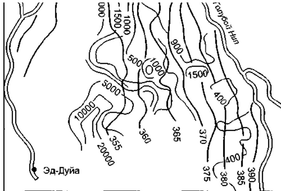
Рис. 13.3. Схема формирования грунтового потока на между-речье Белый Нил—Голубой Нил (Иннетан, 1971): 1 — гидроизогипсы, цифры — абс. отм., м; 2 — изолинии минерализации грунтовых вод, цифры — величина минерализации, мг/л
