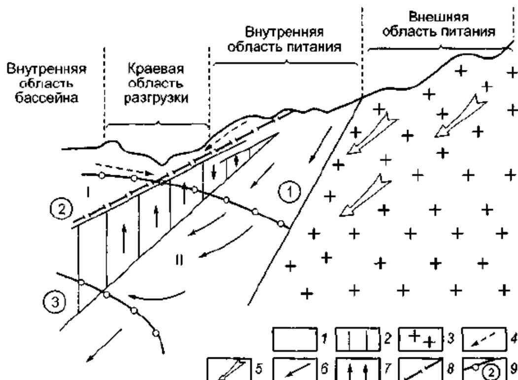
Рис. 10.4. Принципиальная схема формирования потоков полземных вод в краевой части артезианского бассейна платформенного типа:
