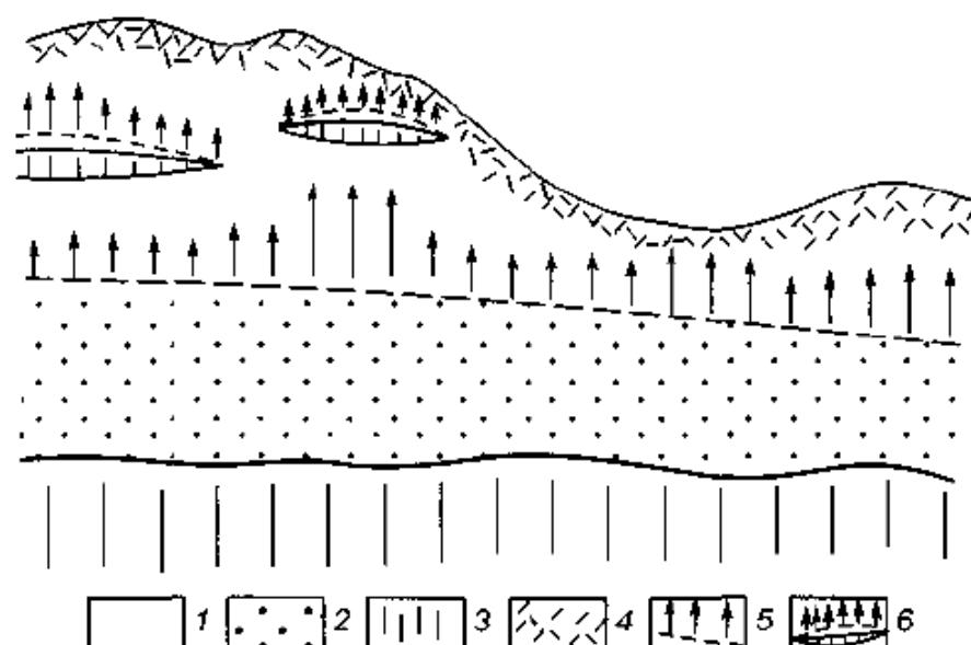
Рис. 7.1. Схема залегания типов подземных вод зоны аэрации:
