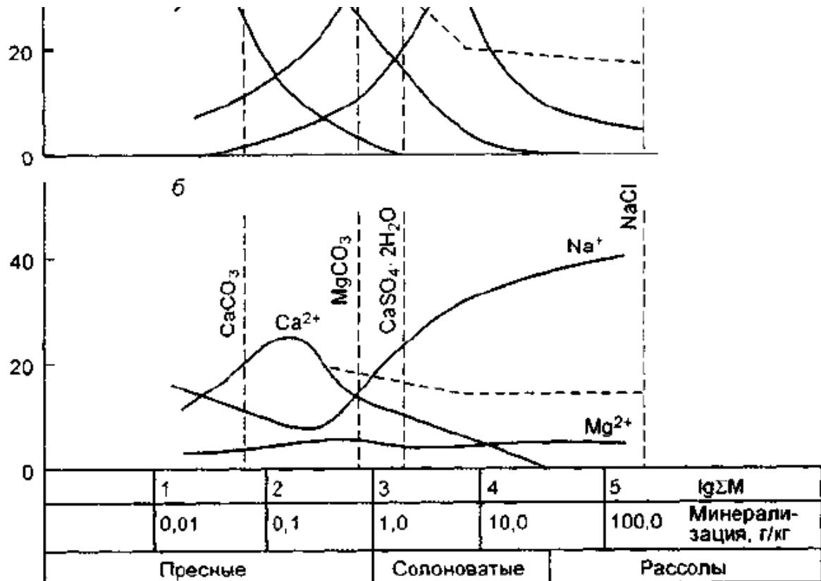
Рис. 4.2. Относительное содержание анионов (а) и катионов (б) в подземных водах различной минерализации (по М.Г. Валянико, 1962). Пунктир — растворимость солей в дистиллированной воде
