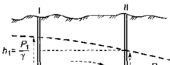
Рис. 5.2. Схема потока подземных вод со свободной поверхностью:
