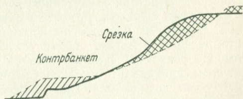
Рис. 41. Укрепление склона путем улоаживания откоса и устройства контрбанкета
