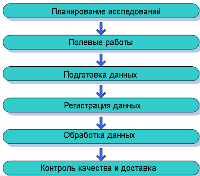
Рисунок 25 - Трубопровод наземного лазерного сканера
