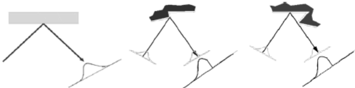
Рисунок 19 - Идеальное отражение, частичное освещение, частичная окклюзия
