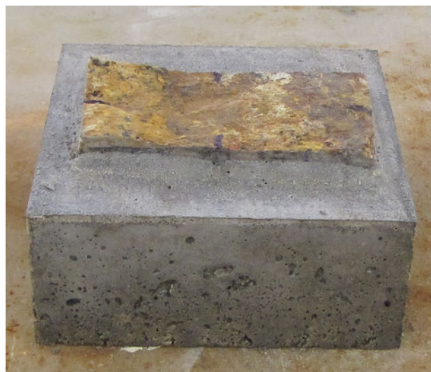
Рис. 3 Изоляция нижней половины образца для испытаний прямоугольной формы
